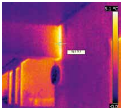
Termografering med varmekamera fanger opp forskjeller i konstruksjonens overflatetemperatur. Dette ble gjort med Vigvoll Terrasse Borettslag, og termobildene viser en sterk varmestrom ved drageren som fører varmen ut av bygget.
