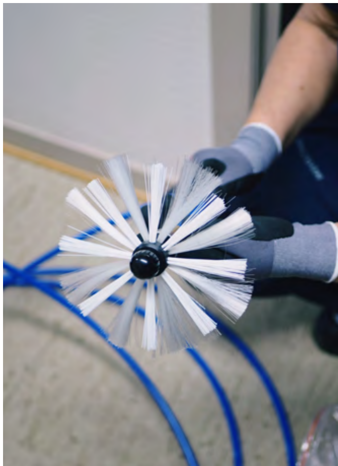
⤴ - En roterende børste benyttes til rens av kanalene.
