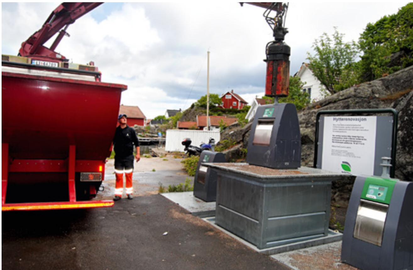
De nedgravde avfallskontainerne heises opp fra bakken og tømmes på stedet av renovasjonsbilen fra Avfall Sør.
